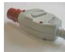
CEE - Motorschutzstecker mit Phasenwender, Bi-Metall, Drehrichtungskontrolle, Betriebsschalter. Das Gerät ist autark an eine CEE - Steckdose anschließbar.
